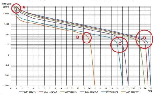
带银触点快动作机械装置的平均大概数值。
